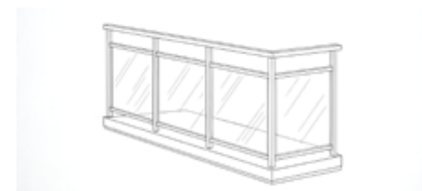
Baranda de estructura metálica con vidrio.
