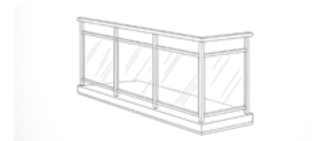
Baranda de estructura metálica con vidrio.
