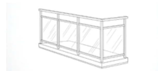
Baranda de estructura metálica con vidrio.
